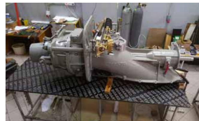
Водометный движитель ВД370Д: максимальная мощность 950 кВт
